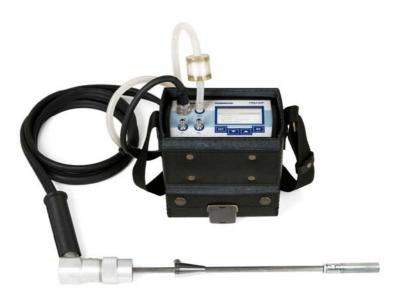
Принцип действия газоанализатора основан на применении комплекта электрохимических и оптических датчиков для измерения содержания газовых компонент анализируемой пробы, термоэлектрического преобразователя (термопары) типа «К» для измерения температуры газового потока, дифференциального полупроводникового датчика для измерения избыточного давления (разрежения) и в комплекте с пневмометрической напорной трубкой типа Пито или НИИОГАЗ для определения скорости и объемного расхода газового потока.
