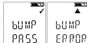
После успешного тестирования с помощью смеси газов, в режиме измерения, в течение 24 часов, отображается символ √.
